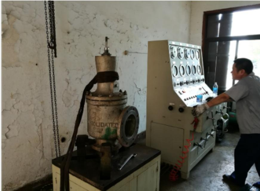
安全阀是一种自动阀门，他不借助任何外力而利用介质本身的力来排出额定数量的流体，以防止系统内压力超过预定的安全值。当压力恢复正常后，再自行关闭并阻止介质继续流出的一种阀门，包括直接载荷式安全阀、先导式安全阀、动力辅助装置的安全阀等。安全阀定期校验，一般每年至少一次，安全技术规范有相应规定的从其规定；经解体、修理或更换部件的安全阀、应当重新进行校验。离线校验：指在离线状态下，将安全阀从设备上拆下，对安全阀进行的校验。校验项目包括整定压力及密封试验压力。在线校验：指在在线状态下（安全阀安装在设备上受压或不受压状态下）对安全阀进行校验。校验项目为整定压力。安全阀属于超压泄放装置中的一种，超压泄放装置又包含了多种不同类型的阀门。无锡安全阀校验地址
