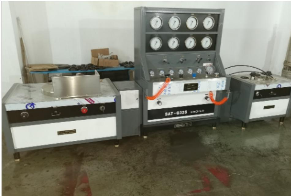
安全阀校验流程有安全阀安装前应进行耐压试验和气密性试验，以检查安全阀的强度和密封性能。校正和调整只能在合格后进行。在气体试验台上，通过调整阀门上施加的负载来纠正安全阀的开启压力。杠杆安全阀调整重锤位置，弹簧安全阀调整弹簧压缩量。安全阀的开启压力应符合锅炉和压力容器安全技术监督程序的有关规定。在容器上，通过调整安全阀调节环与阀门之间的间隙来调节安全阀的排放压力和回座压力。如果安全阀在开启压力下只有泄漏而不跳跃或起跳，但压力下降后有剧烈振动和蜂鸣的声音，间隙过大，应调整得更小。如果回座压力过低，调节环之间的间隙过小，应适当调整。蒸汽安全阀的排放压力应小于或等于开启压力的1.03倍，开闭压差不应大于开启压力的10%。空气或其他气体的排放压力应小于或等于开启压力的1.10倍，开闭压差不应大于开启压力的15%。安全阀进行校准和压力调整时，使用单位负责锅炉压力容器安全的技术人员必须在场。调整和校准装置的压力表精度不得低于1级，在线调整时应采取安全防护措施。在校准过程中，校准人员应及时做好记录。安装相关附件装置后，合格的安全阀进行密封，防止调整状态随意改变。
